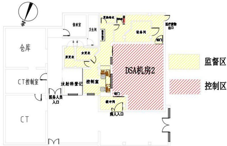
图 3-2 本项目 DSA 机房 2 两区划分示意图
